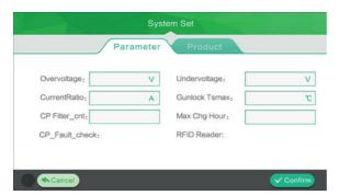
In questa schermata è possibile impostare il valore di sovratensione (predefinito 253V), il valore di sotto tensione (predefinito 187V), la corrente di uscita nominale (predefinito 32A), il valore di surriscaldamento connettore (predefinito 95°C). Questi parametri predefiniti sono stati impostati in fabbrica e non necessitano di essere impostati.
