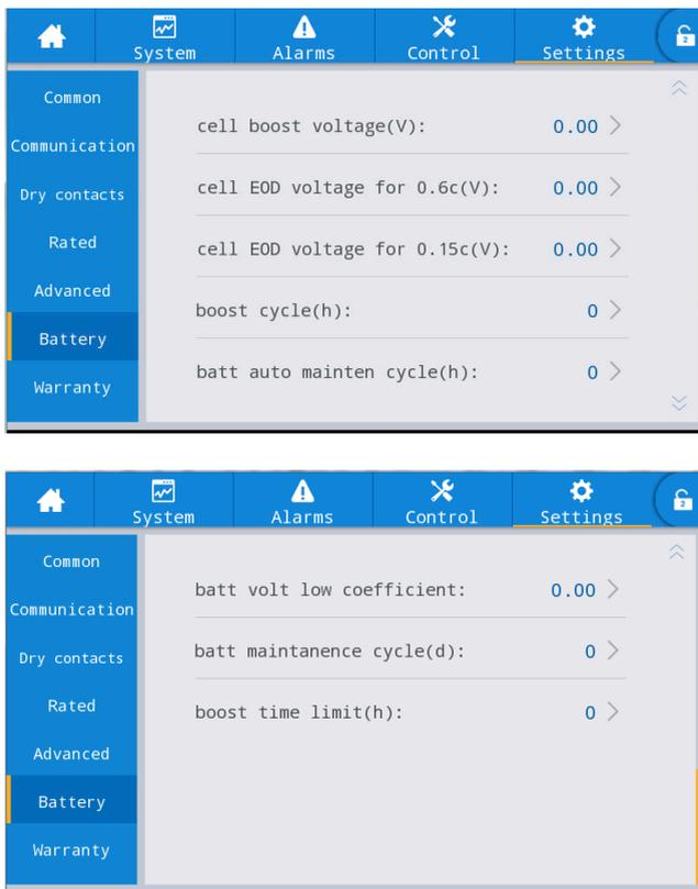
Fig. 4-19 Interfaccia dei parametri della batteria
