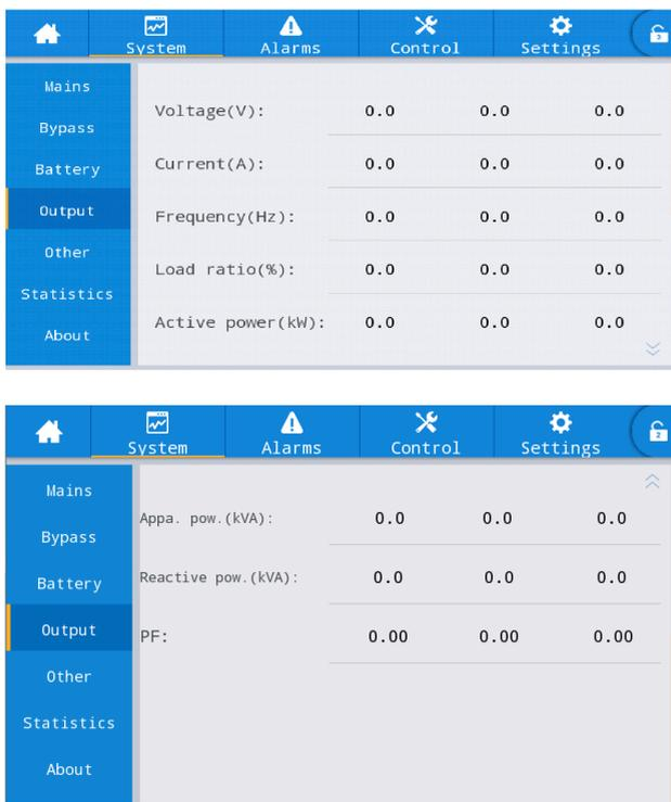
Fig. 4-7 Interfaccia di uscita
