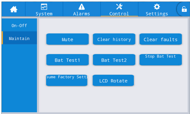
Fig.5-2 Manutenzione delle batterie
