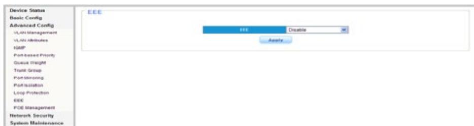
Si tratta di una serie di miglioramenti per ridurre la potenza necessaria per Ethernet prima che lo standard è stato ratificato, con il nome di Ethernet verde.
