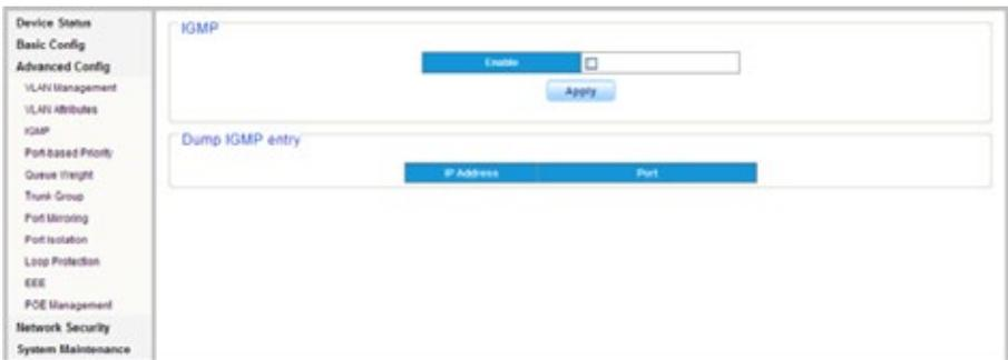
L'immagine sopra è l'interfaccia configurazione IGMP, settaggio IP per le porte router.
