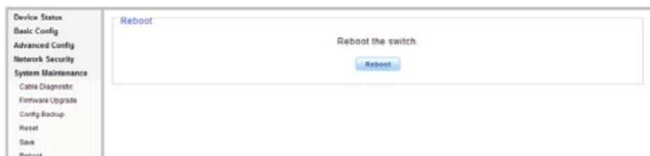
L'aggiornamento del software e alcune configurazioni possono funzionare solo dopo il riavvio del sistema dello switch, riavviare lo switch
