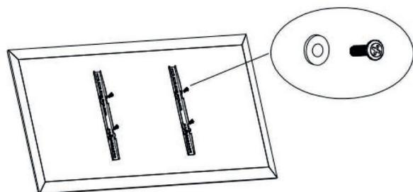
Posizionare i lati piatti delle staffe sul retro del monitor in modo che si allineino ai fori del monitor.
