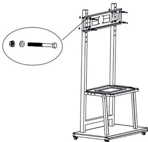
Utilizzare 4 viti esagonali M8x70 insieme a 4 rondelle per montare la staffa di supporto del monitor e stringerle con 4 dadi sul telaio principale.
