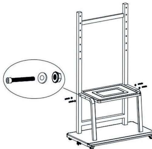
Utilizzare 4 viti esagonali M8x60 e 4 rondelle per fissare il vassoio centrale, stringendo con quattro dadi.
