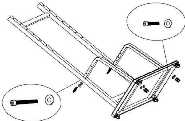
Utilizzare 4 viti esagonali M8x60 e 4 rondelle per fissare saldamente i due sostegni di supporto al telaio principale. Successivamente utilizzare 4 viti esagonali M8x40 e 4 rondelle per fissare i tiranti di supporto alla base.
