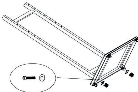
Utilizzare 8 viti esagonali M8x40 insieme a 8 rondelle per fissare la base al telaio principale.
