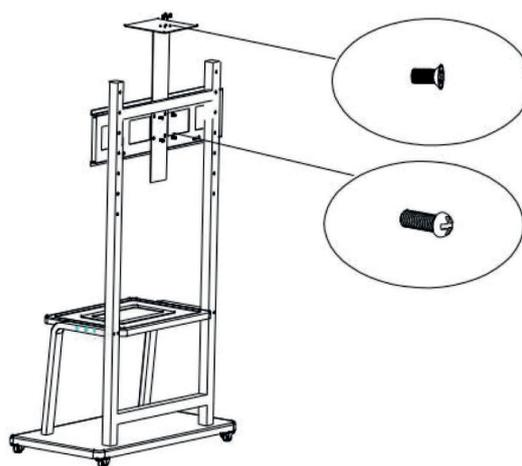
Utilizzare 4 viti con testa svasata M5x8 per fissare il supporto alla base. Successivamente, posizionare il supporto alla staffa di supporto del monitor e fissarlo con 4 viti M6x16.
