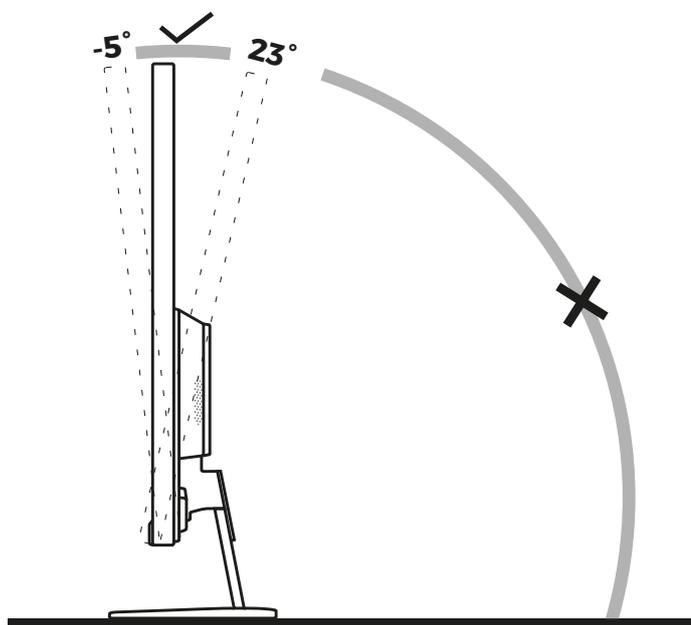
Per scegliere il miglior angolo di visuale, si consiglia di posizionarsi davanti al monitor. Per evitare di toccare il monitor nell'operazione di impostazione dell'angolo di visuale, mantenere la staffa della base.
