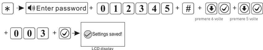
L'intervallo di tempo del test di comunicazione può essere impostato da 0-999 ore. Dopo aver completato le impostazioni, si tornerà automaticamente alla schermata precedente.
